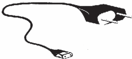
Anschlussleitung mit verschweißtem Flachstecker nach DIN 49464 und verschweißter Gerätesteckdose nach DIN 49455 als unteilbares Ganzes
